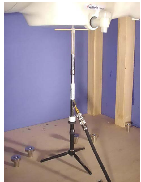
900MHz Dipole Setup
